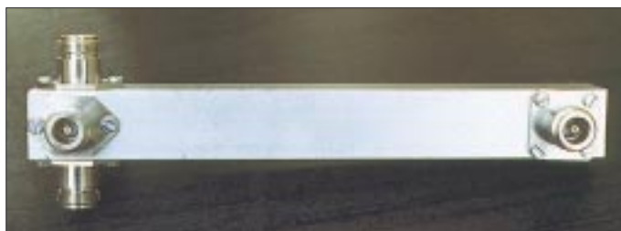
Bild 8: Selbstgebauter Vierfachverteiler für das 70-cm-Band
