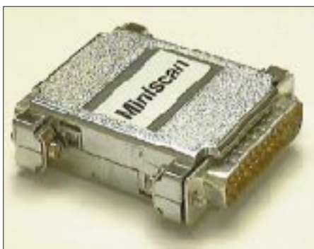
Bild 3: „Miniscan“ von CombiTech gehört ebenfalls zu dem Einstiegsprogramm von PA3GPY und bietet bereits einen echten Sinusgenerator.
