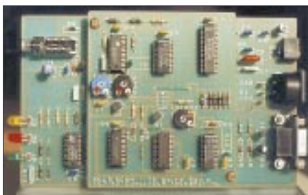
Bild 5: Das Innenleben des Multiscan-Konverters von PA3GPY. Die Sendeleiterplatte ist über einen achtpoligen Steckverbinder (CN 1) mit dem Empfangsteil verbunden und von zwei Distanzbolzen gehalten. Durch dieses Konstruktionsprinzip läßt sich das Sendeteil auch später nachrüsten.
